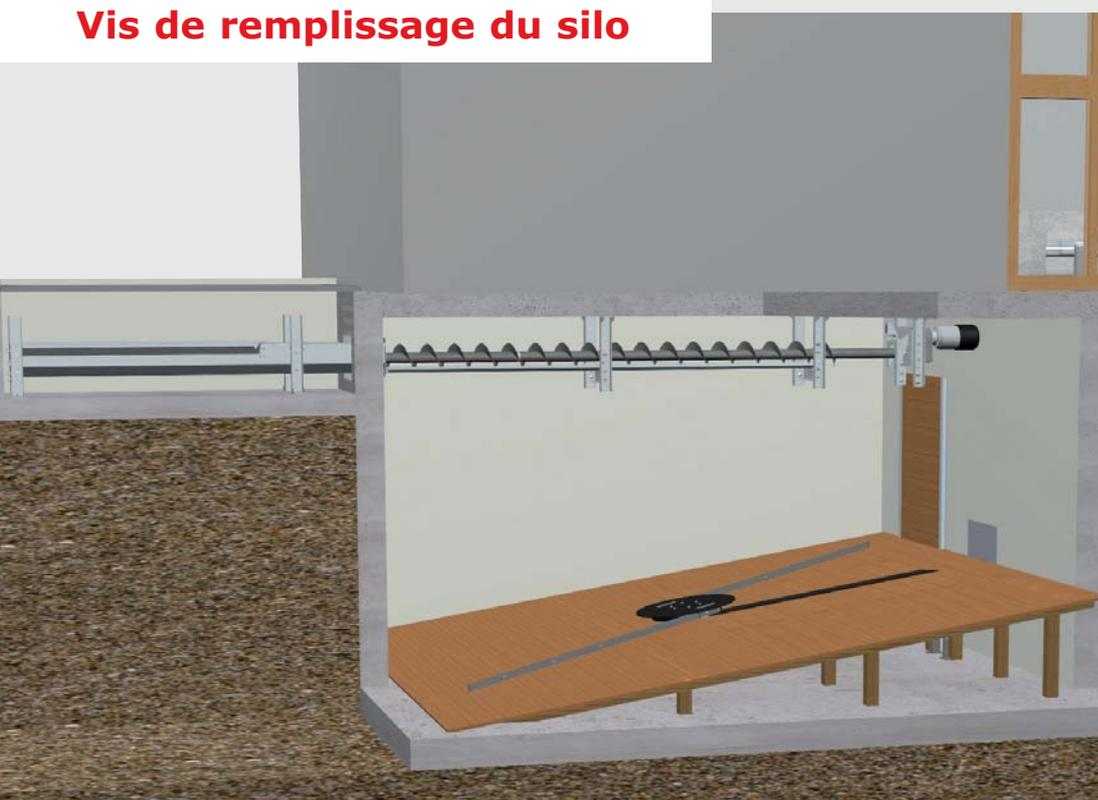
La vis de remplissage du silo transporte le combustible en toute fiabilité jusqu'au silo et s'arrête automatiquement lorsque le silo est plein.
