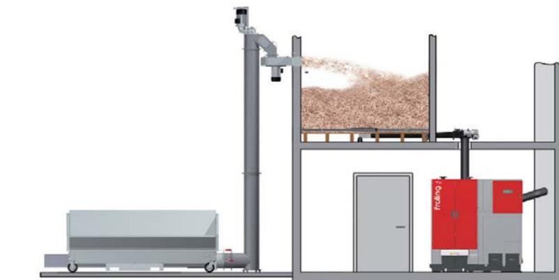
Le silo se trouve au-dessus du niveau d'accès. L'alimentation en combustible jusqu'à la chaudière s'effectue au moyen d'un tuyau de descente. Dans ce cas, l'utilisation d'une écluse à roue cellulaire est recommandée. Le silo peut être rempli facilement à l'aide d'une vis de transport verticale ou par soufflage du combustible.
