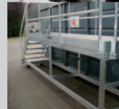
Escalier accès bennes
