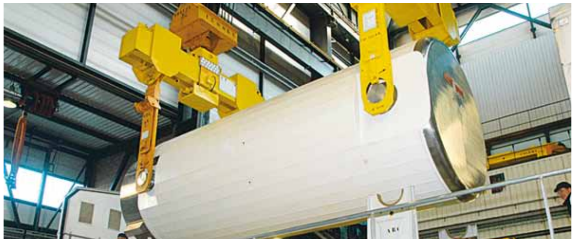
Emballage de transport dans lequel seront placés les colis de déchets HA. Ces emballages seront contrôlés avant d'être expédiés.
