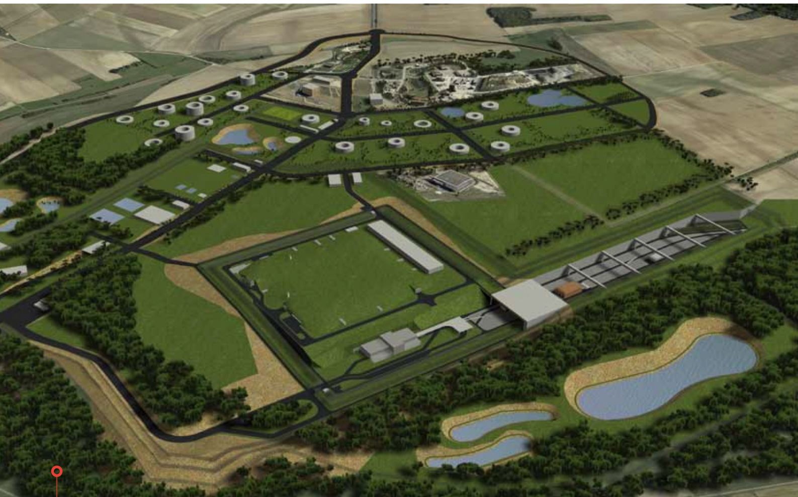
Vue générale de la zone de surface dédiée à la réception, au contrôle et à la préparation des colis - schéma de principe avec l'hypothèse d'un terminal ferroviaire implanté sur le site.
