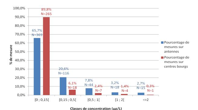
Figure 1 : Répartition des concentrations en chlorure de vinyle mesurées en des points de prélèvements situés en antennes et en centres bourgs lors de la campagne nationale sur les réseaux à risques menée par le LHN entre août 2011 et mars 2012
