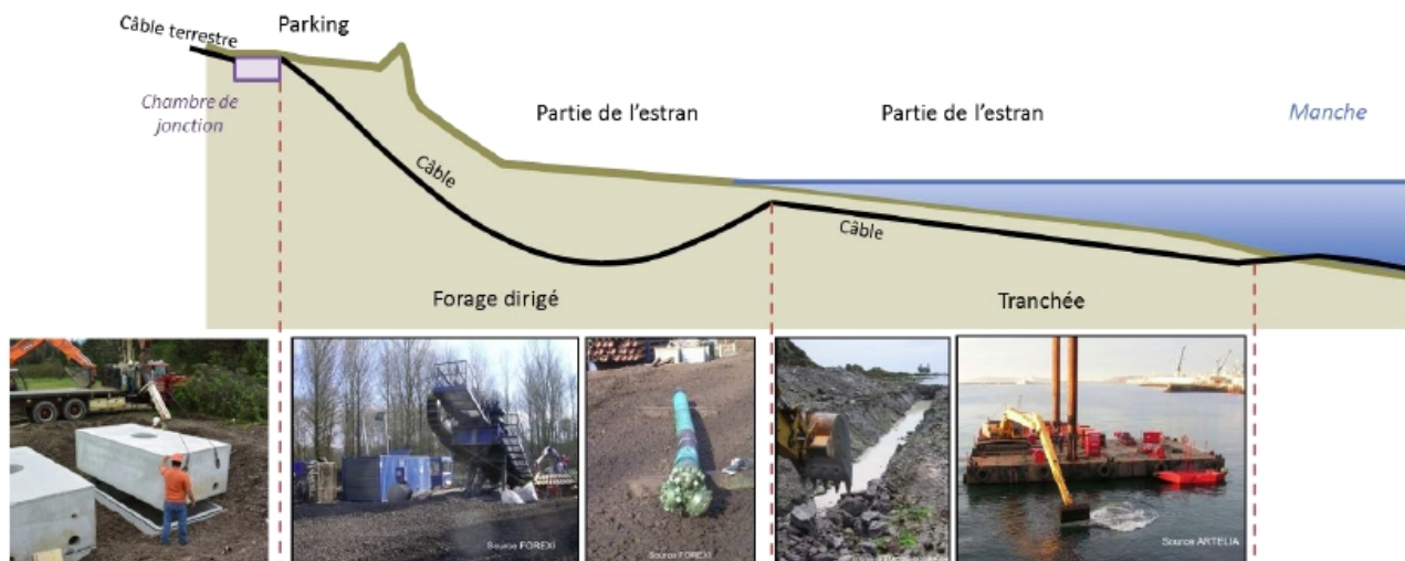
Figure 4 : coupe de principe de la solution technique d'atterrage (Source : Artélia, 2015)
