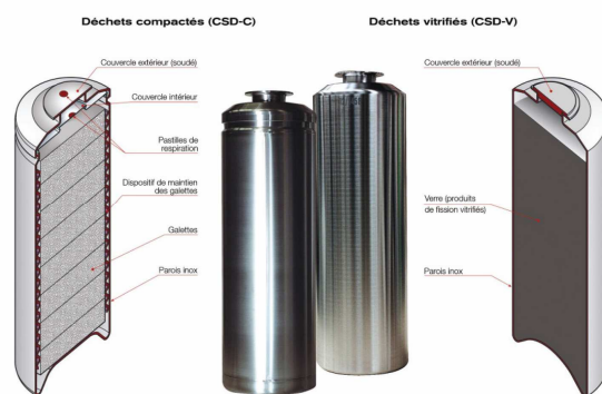
Figure 3 : Conteneurs standards de déchets vitrifiés (CSD-V) et de déchets compactés (CSD-C)
