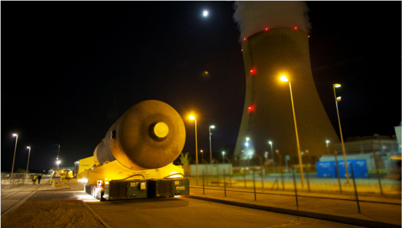
Centrale de Cruas-Meyssse : transfert d'un générateur de vapeur usé vers son bâtiment d'entreposage.
