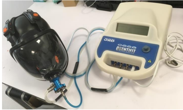
Figure 6 : Montage pour l'essai d'ajustement au Quantifit
