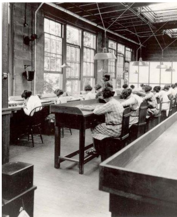
Ouvrières (« radium girls ») peignant des aiguilles de cadrans lumineux au radium dans l'usine US Radium (United States Radium Corporation) à Orange dans le New Jersey – 1922
