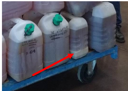
Figure 8 : Précipité visqueux collecté dans la cuve de stockage des urines, projet Azuris.
