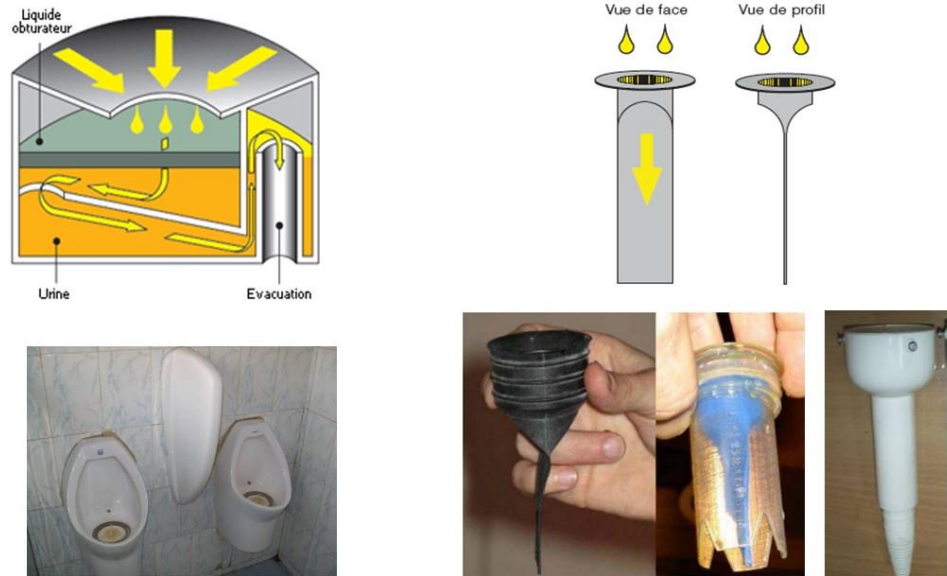
Siphon à cartouche (à étanchéité liquide)
