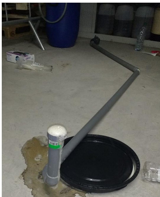
Figure 16 : Mise en charge d'une portion de réseau (PVC Ø 50 mm) avec du vinaigre blanc
