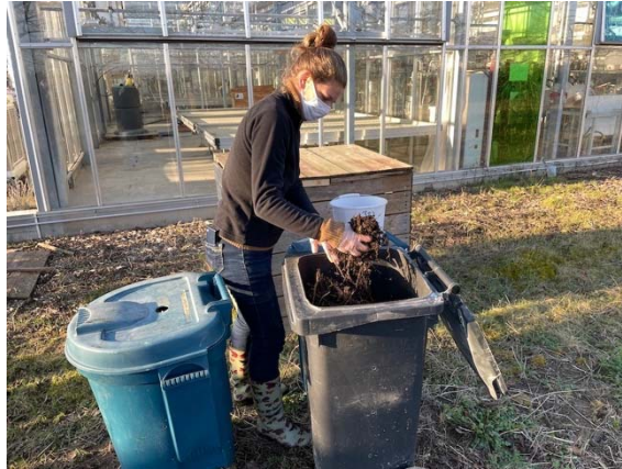
Photo 10 : Echantillonnage des broyats de déchets verts pour la mesure de la masse volumique et les analyses agronomiques.
