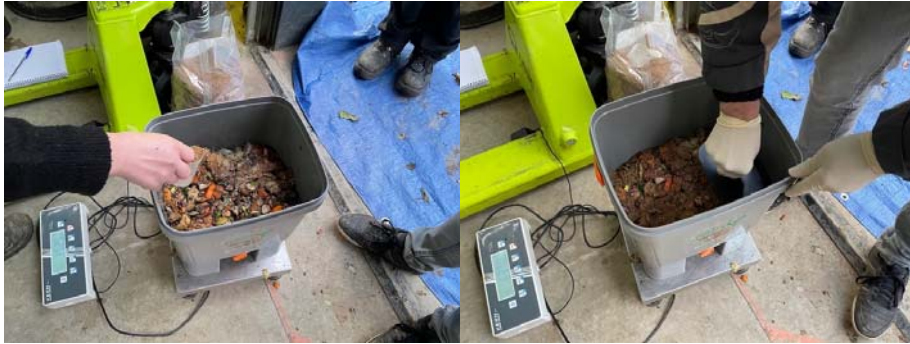
Photo 14 : Mise en place du bokashi : alternance des apports DCT/son de blé puis tassement
