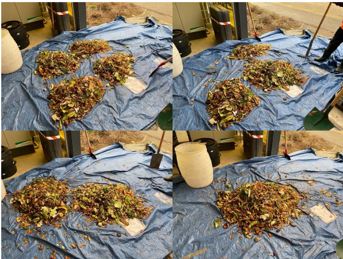
Photo 6 : Homogénéisation par quartage des DCT pour le lombricompostage (lot 2, 15/03/2022)
