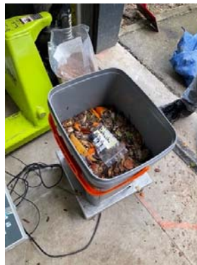
Photo 15 : Insertion d'une pile-bouton au cœur du seau Bokashi pour le suivi de la température
