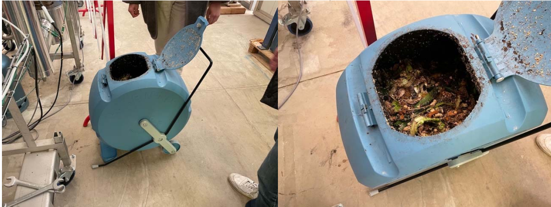
Photo 13 : Mise en place du composteur rotatif (gauche) et DCT en mélange avec les granulés bois (droite)
