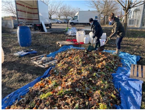
Photo 2 : Homogénéisation par quartage des DCT pour le compostage en bac, le compostage rotatif, les bokashis et le déshydrateur (lot 1, du 12 au 17/11/2022)
