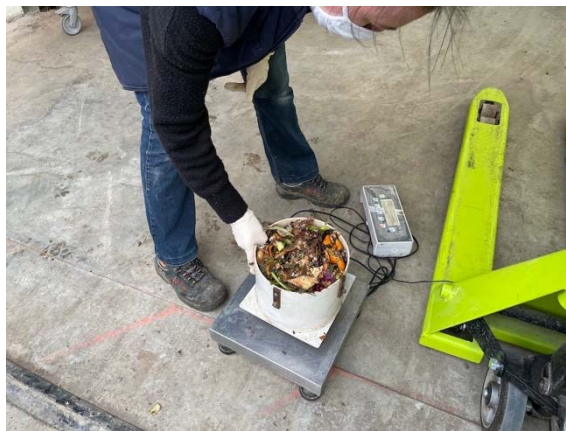
Photo 8 : Mesure de la masse volumique
