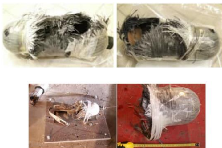
Figure 132 : Eclatement d'une bouteille de 2,4 L à une pression de 700 bar après un impact mécanique
