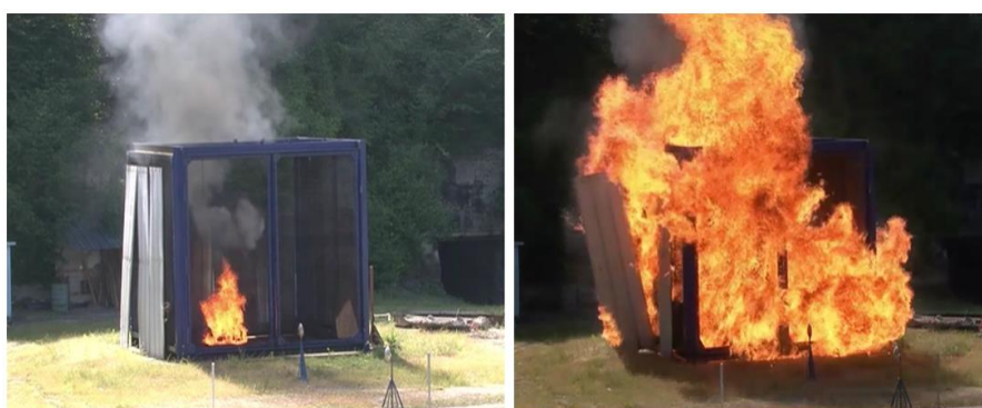
Figure 82 : Eclatement d'un réservoir d'hydrogène (2,4 L à 700 bar) pris dans un feu
